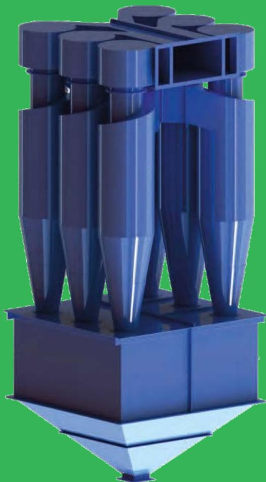
**Циклон** – аппарат, используемый в промышленности для очистки газов или жидкостей от взвешенных частиц. Принцип очистки — инерционный (с использованием центробежной силы). Циклонные пылеуловители составляют наиболее массовую группу среди всех видов пылеулавливающей аппаратуры и применяются во всех отраслях промышленности в системах аспирации и пневмотранспорта.
